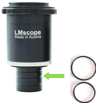
**Optional:** Je nach Mikroskop-Hersteller und Modell kann der Innendurchmesser des Okulartubus einige Zehntelmillimeter vom Sollmaß abweichen. Daher sind im Lieferumfang mehrere unterschiedliche O-Ringe enthalten. Diese ermöglichen eine exaktere Tubusanpassung.
