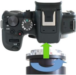
Montieren Sie den LM Digital Adapter mithilfe des Bajonetts auf Ihre Kamera. Achten Sie dabei bitte darauf, den Punkt am Bajonettgewinde genau **auf den Punkt am Kameragewinde aufzusetzen**, bevor Sie im Uhrzeigersinn drehen, bis es einrastet. Bei Bedarf halten Sie den Knopf für das Lösen des Kameragewindes gedrückt.
