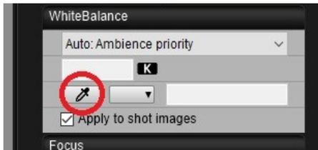
Für hohe Bildqualität und natürlich wirkende Farben sollte ein **Weißabgleich** in der Kamera durchgeführt werden: entweder im Kameramenü mit der Einstellung des Kelvin-Wertes der Lichtquelle oder exakter mithilfe der Steuersoftware am PC.
