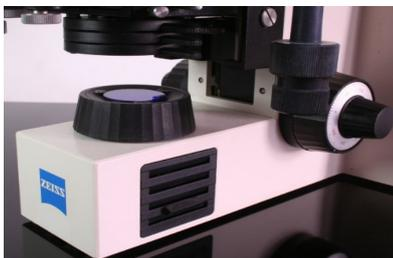
Wenn es die Anwendung zulässt, so ist es empfehlenswert, eine helle Mikroskop-Halogenbeleuchtung, eine LED oder ein Blitzlicht für kurze Belichtungszeiten zu verwenden.
