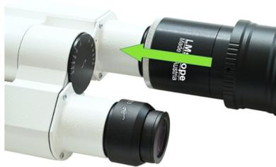
Stecken Sie die gesamte Einheit (LM Digital Adapter und Kamera) in den Okulartubus Ihres Mikroskops.
